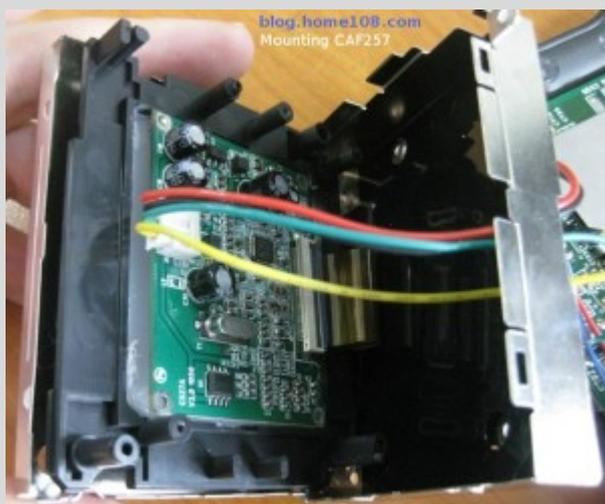
Tandis que les 4 fils rouge (+5-12V), noir (LCD-GND), jaune (CV) et vert sortent hors du boîtier par la fente de l'ancienne limande du bloc-écran d'origine, revissez le boîtier métallique et profitez-en, même si ça ne sert strictement à rien, pour relier à la masse le fil vert (Composite-GND) à l'une des vis. Nettoyez bien les poussières à l'intérieur de la glace de protection et sur l'écran avant de revisser votre nouveau bloc-écran « modded ».
